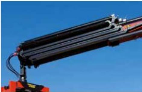
**EQUIPAMIENTO DE MANGUERAS PARA DISPOSITIVOS ADICIONALES VERSÁTIL Y FÁCIL DE USAR**
