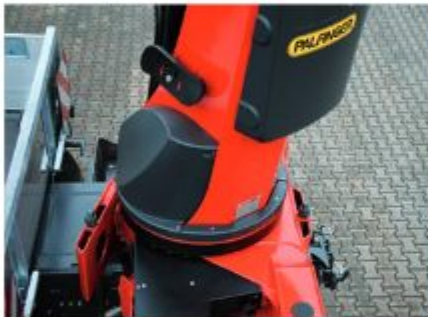
Sistema de rotación continua Movimiento sin restricciones
