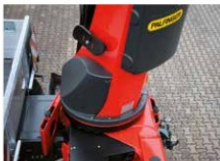
Sistema de rotación continua Movimiento sin restricciones
